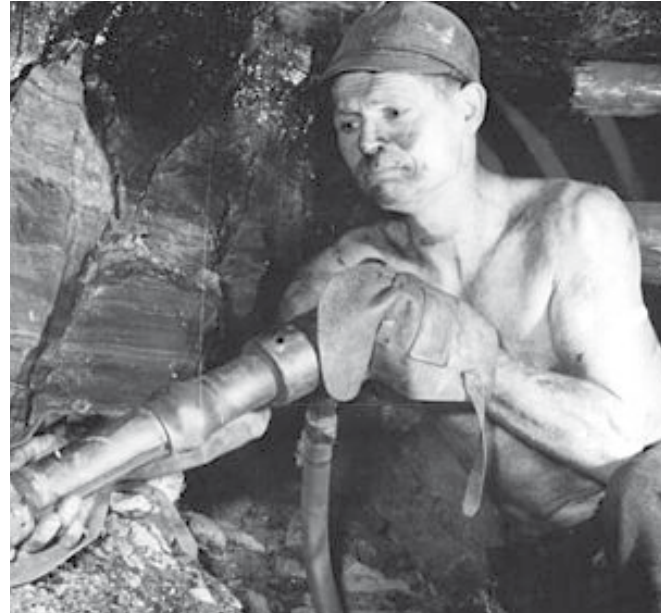
Bild 9: Kohlegewinnung mit Presslufthammer
