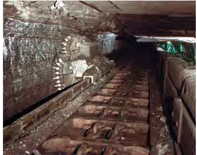
Bild 11: Kohlegewinnung mit Kohlenhobel, auf Doppelkettenstegeförderer fahrend
