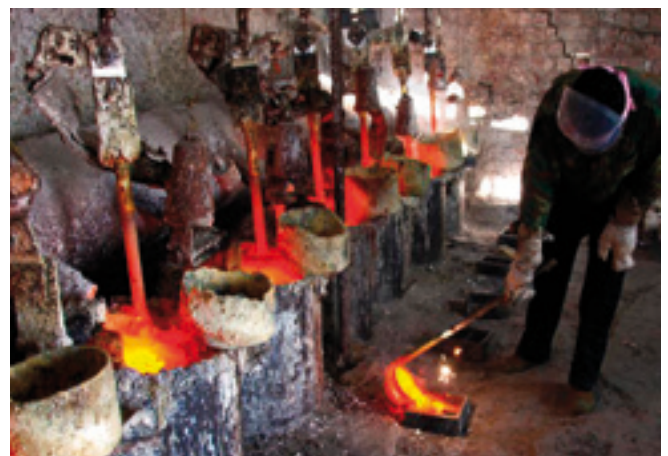
Bild 6: Erschmelzen von Seltenerdmetallen
